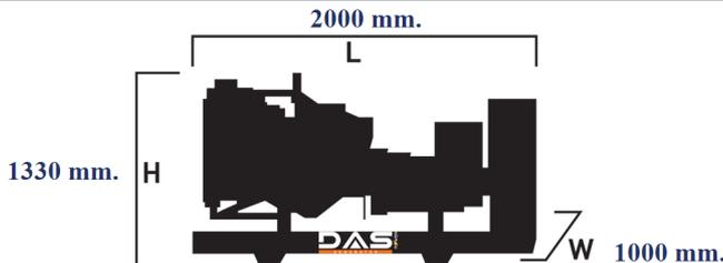
Islak Ağırlık: 840 kg. Yakıt Tankı Kapasitesi: 138 L
