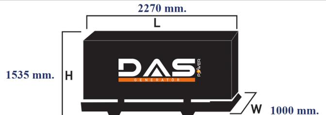
Islak Ağırlık: 975 kg. Yakıt Tankı Kapasitesi: 138 L
