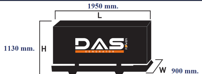
Islak Ağırlık: 650 kg. Yakıt Tankı Kapasitesi: 65 L
