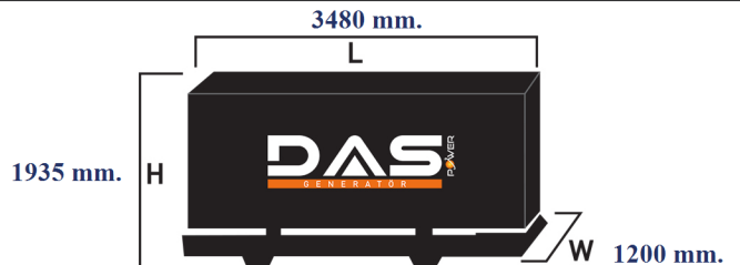
Islak Ağırlık: 2260 kg. Yakıt Tankı Kapasitesi: 245 L
